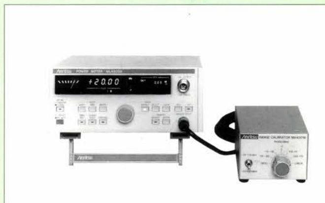
レンジ校正器MA4001Aによる指示計の校正
