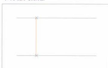
任意の2点で指定した直線と、それに平行な線を別に指定することで、2本の平行する線間の最短距離を計測できます。
