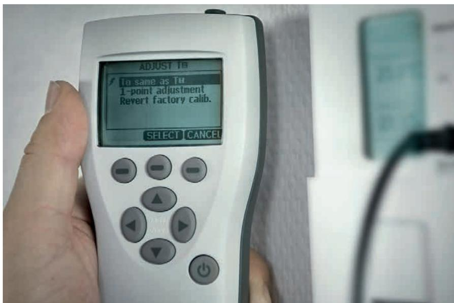
MI70 ハンディタイプ指示計は、センサプローブと組み合わせて現場でのチェックに使用できます。
